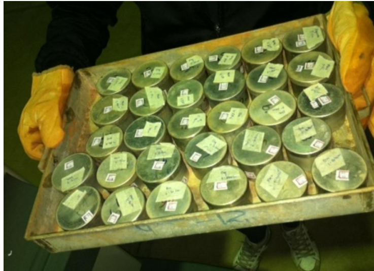
Figura 17 - Amostra de solo para determinação da umidade
